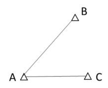
坐標值單位均為m。請計算 $\overline{AC}$ 距離為何? $\overline{AB}$ 與 $\overline{AC}$ 方向之方位角分別為何?由 $\overline{AB}$ 方向順時針計算之夾角 $\angle BAC$ 為何?若已知 $\overline{AB}$ 在全測站度盤上的方向值為359°59'20",則 $\overline{AC}$ 在全測站度盤顯示幕上的方向讀數應該為何?(35分)
