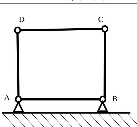
四、完成以下鋼架之剪力與彎矩圖，並詳列計算過程。(30分)
