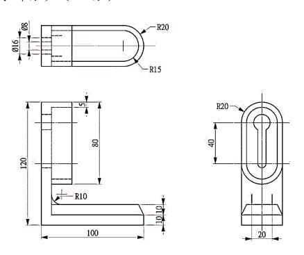
三、請依下列正投影三視圖所示之尺度,以第三角法1:1比例繪製前視圖之剖面圖 (須依割面線方位繪製,不須標註尺度)。(25分)
