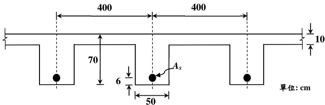
二、一簡支獨立倒 T 型梁如下所示，受均佈設計（因數化）載重  $w_u = 15 \text{ tf/m}$ （含自重）。混凝土抗壓強度  $f'_c = 280 \text{ kgf/cm}^2$ ，鋼筋降伏強度  $f_y = 4200 \text{ kgf/cm}^2$ 。一支 D13 鋼筋斷面積為  $1.267 \text{ cm}^2$ 。混凝土抗剪強度  $V_c = 0.53\sqrt{f'_c}b_wd$ 。
