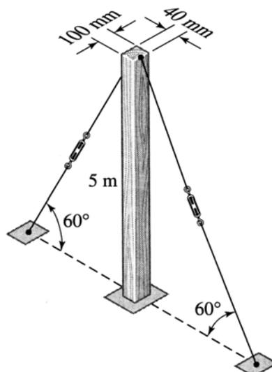
三、如圖所示桁架結構，每根桿件的截面積為  $500 \text{ mm}^2$ ，楊氏模數為  $E=200 \text{ GPa}$ 。
