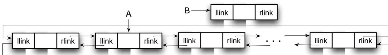
(一)在 A 所指向節點之右鏈結 (rlink) 插入由 B 所指向的一個新節點。(6分)
