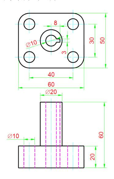
二、請依下列等角圖所示之尺度(單位:mm),以第三角法1:1 之比例繪製三視圖(不須標註尺度,須有隱藏線,三視圖須在同一頁面)。(25分)
