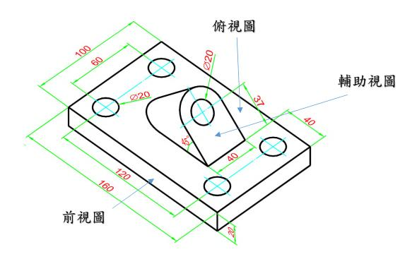
四、請依下列正投影三視圖所示之尺度(單位:mm),以第三角法1:1 比例 繪製該零件之俯視圖、右側視圖,並將前視圖改為剖面圖(須標註尺度, 三視圖須在同一頁面)。(25分)
