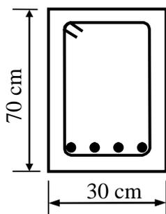
四、有一矩形斷面之鋼筋混凝土梁，梁斷面寬度  $b=30\text{ cm}$ ，有效深度  $d=53\text{ cm}$ 。梁斷面承受設計剪力  $V_u=30\text{ tf}$ 。梁配置 D13 閉合矩形剪力鋼筋，剪力鋼筋之混凝土淨保護層為  $4\text{ cm}$ 。混凝土  $f'_c=210\text{ kgf/cm}^2$ ，剪力鋼筋降伏強度  $f_{yt}=4200\text{ kgf/cm}^2$ 。一支 D13 鋼筋之直徑  $d_b=1.27\text{ cm}$ ，截面積  $A_b=1.27\text{ cm}^2$ 。試計算所能容許之剪力鋼筋最大間距。（25 分）
